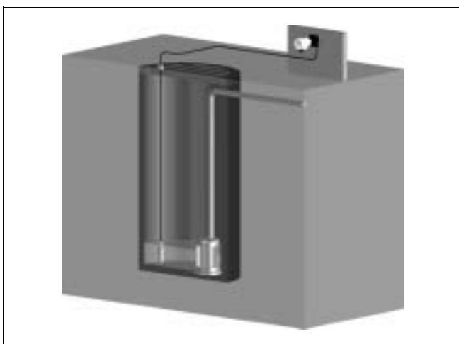
Fig. 3: Montagevoorbeeld: uitvoering met draagkabel in pompput
